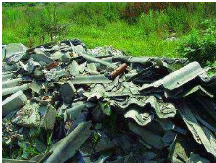
18.5.1.1.1.1.1.1 Zdjęcie 13 Nielegalne wysypiska odpadów azbestowych w lesie
