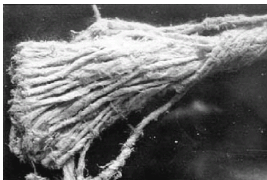
18.4.1.1.1.1.1.7 Zdjęcie 12 Sznur azbestowy stosowany w uszczelnieniach izolacji cieplnej
